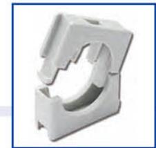
Abrazadera clip **cerrada** adecuada para la sujeción de tuberías eléctricas o cables con aislamiento de goma, mediante el encaje a presión de la parte superior de la abrazadera. Las pestañas interiores flexibles **permiten movimientos longitudinales**. Puede ser utilizada en **instalaciones paralelas**. Fabricada en Polipropileno.
