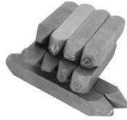
Os punções manuais com caracteres especiais da série 300 são utilizados para marcação sem problemas de peças de trabalho com uma resistência até 900 N/mm<sup>2</sup> (27 HRC). Os socos têm uma dureza na gravura entre 58 e 61 HRC. Os caracteres especiais podem ser facilmente encomendados por número de artigo.
